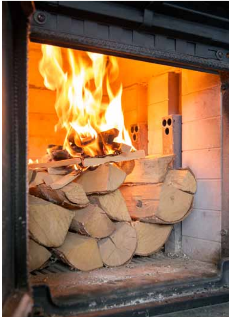
Ekotakan tulipesän reunoilla on ilmanavat, jotka pitävät klapit irti sivuseinistä. Ilmanavien yläosassa on reikiä, joista esilämmitetty toisioilma suihkuu puiden päälle. Sytyttämisessä kannattaa käyttää apuna tikkuja ja tuotta.
